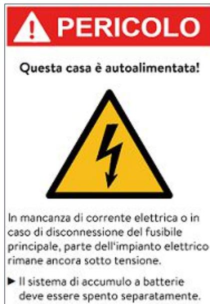
Figura 8: Adesivo da applicare sul quadro elettrico
