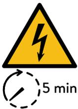
All'interno del sonnenProtect vi sono parti conduttrici di tensione, pertanto vi è pericolo di scossa elettrica. Inoltre, nell'inverter del sistema di accumulo vi sono condensatori presso i quali è presente tensione anche dopo lo spegnimento del sistema di accumulo. Poiché il sonnenProtect è collegata con l'inverter del sistema di accumulo, la tensione dell'inverter è presente anche nel sonnenProtect, pertanto:
