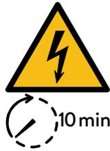
Advertencia de tensión eléctrica. Esperar 10 minutos tras el apagado (tiempo de descarga del acumulador interno de energía).
