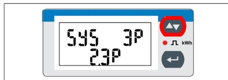
Figura 20: Pagina del display SYS - dopo la modifica della modalità di misurazione
