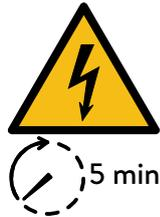
Attenzione pericolo per presenza di tensione elettrica Dopo lo spegnimento attendere 5 minuti (tempo di scarica dei condensatori).
