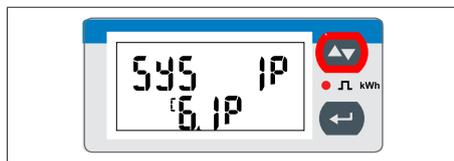
Fig. 18: Página SYS - Cambiar el modo de medición
