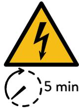
Advertencia de tensión eléctrica. Esperar 5 minutos tras el apagado (tiempo de descarga del acumulador interno de energía).
