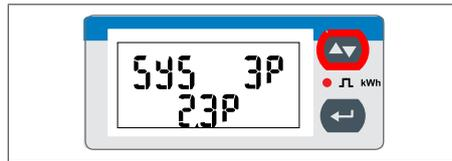
Abb. 18: Displayseite SYS - Ändern des Messmodus
