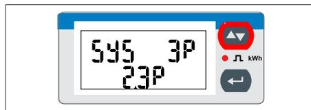
Abb. 20: Displayseite SYS nach Änderung des Messmodus
