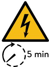
Warnung vor elektrischer Spannung. Nach dem Ausschalten 5 Minuten warten (Entladezeit der internen Energiespeicher).
