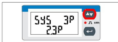
Figura 35: Pagina del display SYS - dopo la modifica della modalità di misurazione
