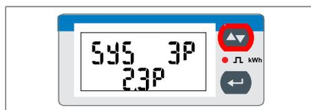
Fig. 35: Página SYS tras el cambio del modo de medición
