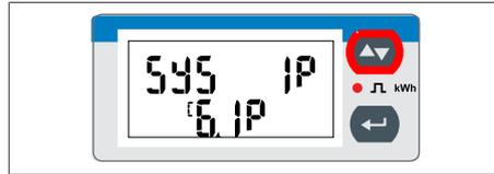
Fig. 33: Página SYS - Cambiar el modo de medición
