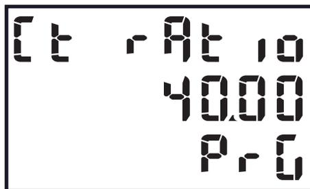
Figura 28: Pagina del display Ct rAtio impostata su un rapporto di trasformazione 40
