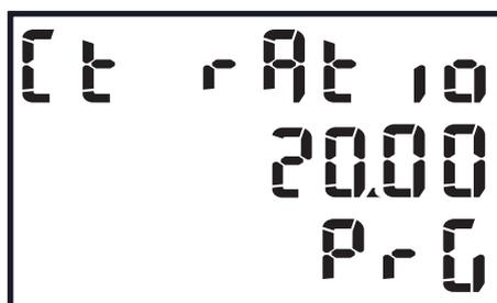
Figura 29: Pagina del display Ct rAtio impostata su un rapporto di trasformazione 20
